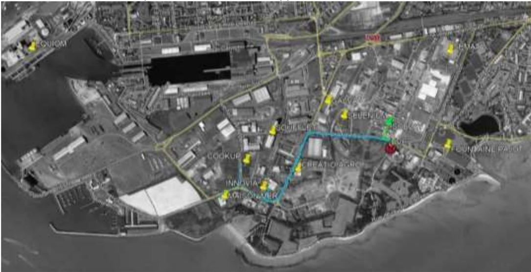
Ainsi, une extension du réseau de chaleur en eau chaude basse pression (de l'ordre de 100°C) pourrait permettre de substituer une partie des consommations de gaz de ces industriels (par exemple pour chauffer de l'eau ou préchauffer l'air process d'INNOVIA). Nous avons considéré l'hypothèse (conservatrice) que le réseau pourrait fournir 3,8 GWh/an de chaleur (correspondant à 25% des besoins utiles d'INNOVIA).
