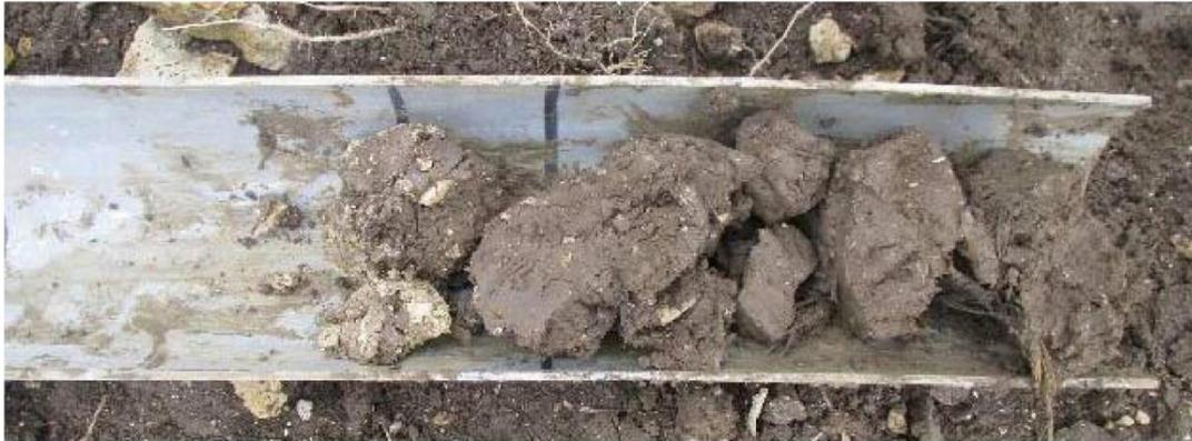
Figure 2 : Sondage pédologique réalisé au point 937 dans la parcelle cultivée en bordure de marais de Vuhé (profondeur de 25 cm)
