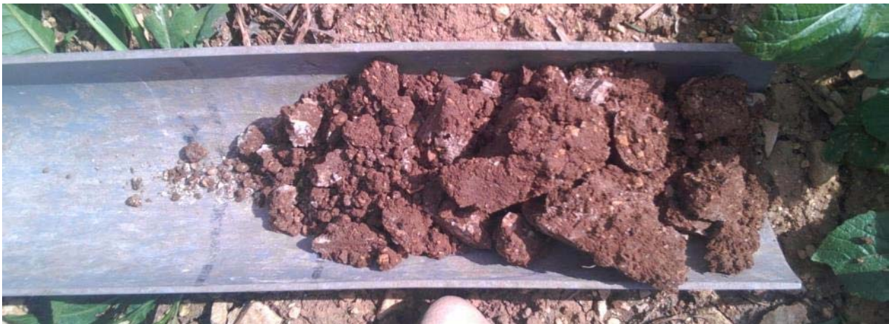
Figure 3 : sondage pédologique de 25cm réalisé au point 3 dans la parcelle cultivée
