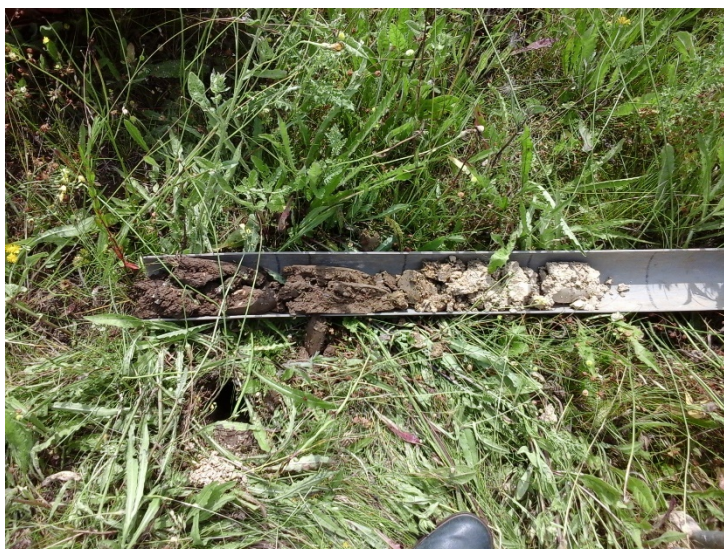
Figure 5 : Photographie d'un sondage présentant des traces d'hydromorphie significatives en profondeur (au-delà de 30 cm) - horizon blanchi lié à un phénomène de déferrification
