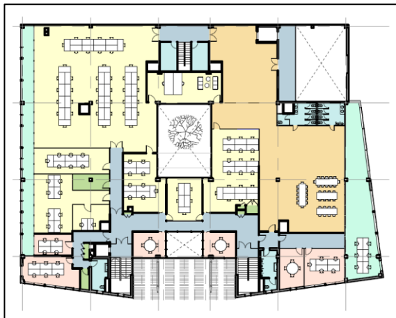
Réhabilitation du bâtiment avec création de loggias (en vert sur le plan) par la CdA (et exemple d'aménagement de l'étage)
