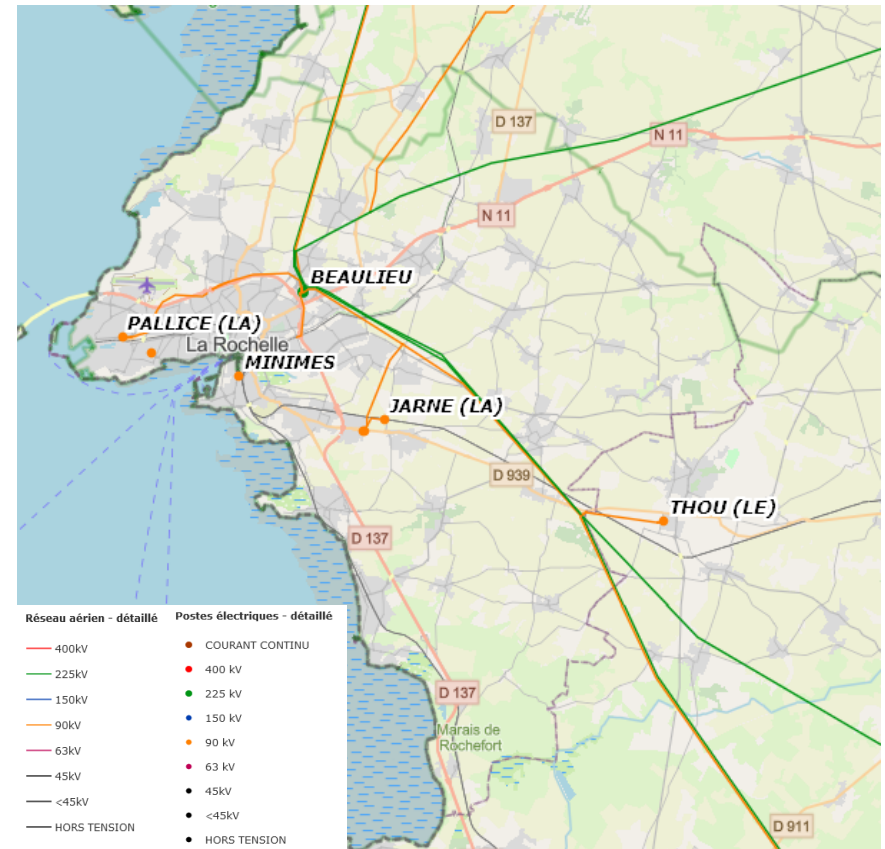
Carte du réseau de transport électrique
