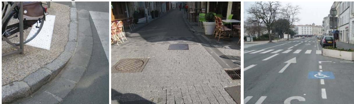
***Trottoir en béton désactivé avec bordure en granit et caniveau en dalles de béton : une dalle podo-tactile située sur le bateau invite le malvoyant à s'arrêter au bord de la chaussée et lui signale la prochaine traversée piétonne. Passage piétons aménagé avec le même revêtement pavé que le trottoir. Passage zébré.***
