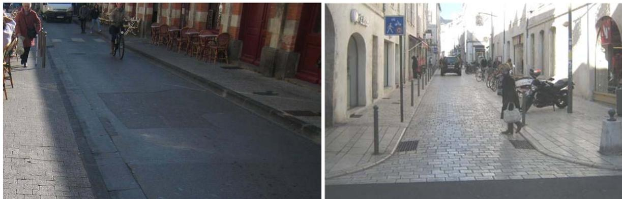
*Un des rares exemples de rue monochrome et à matériau unique (rue St-Michel) : le revêtement en pavés calcaires est disposé perpendiculairement au bâti, le trottoir est délimité par une rangée de potelets et par les fils d'eau. En correspondance des traversées piétonnes, sol en dalles calcaires et bordure du même matériau.*
